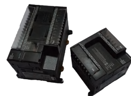
可编程控制器 PLC (PROGRAMMABLE LOGIC CONTROLLER)
